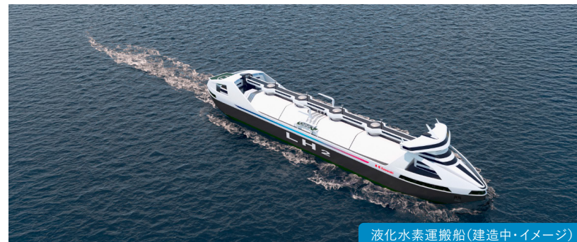
液化水素運搬船（建造中・イメージ）
